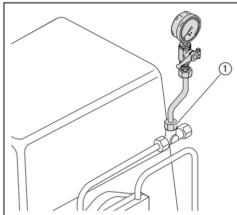
Манометр жидкого топлива в обратной линии
