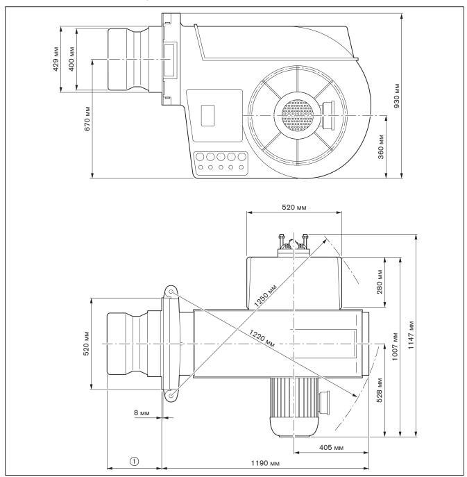
① 407 мм без удлинения пламенной головы 557 мм при удлинении пламенной головы на 150 мм 707 мм при удлинении пламенной головы на 300 мм
