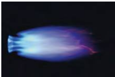
Типичный факел горелки исполнения LowNO x в режиме работы на газе
