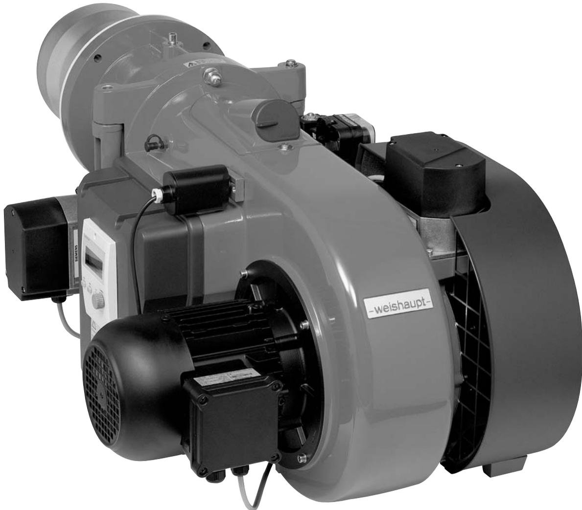
Горелки WM-GL10 серийно являются плавно-ступенчатыми и модулируемыми при работе на газе, и трехступенчатыми или модулируемыми при работе на жидком топливе. Эти исполнения обеспечивают мягкий беспроблемный запуск и высокую эксплуатационную надежность.
